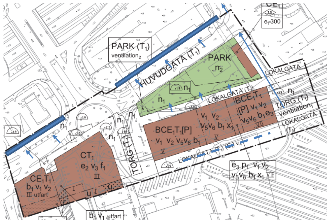
Figur 6. Mörkblå rektanglar visar ungefärlig placering av föreslagna dagvattenmagasin i boulevardens grönremsa, alternativt under GC-bana. Den västra delen behöver vara 230 m 3 och det östra 300 m 3 . Blå pilar visar riktningen dagvattnet rinner. Streckad blå linje illustrerar rörmagasin eller annan fördröjningslösning för den södra lokalgatan.
